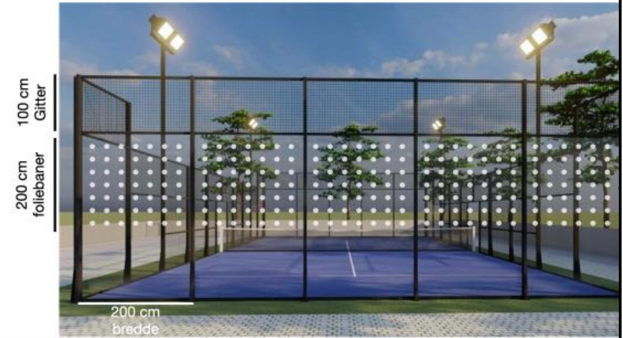
Figur 2: Udformning af foliebaner og klistermærker på endevæggen af en padelbane.
