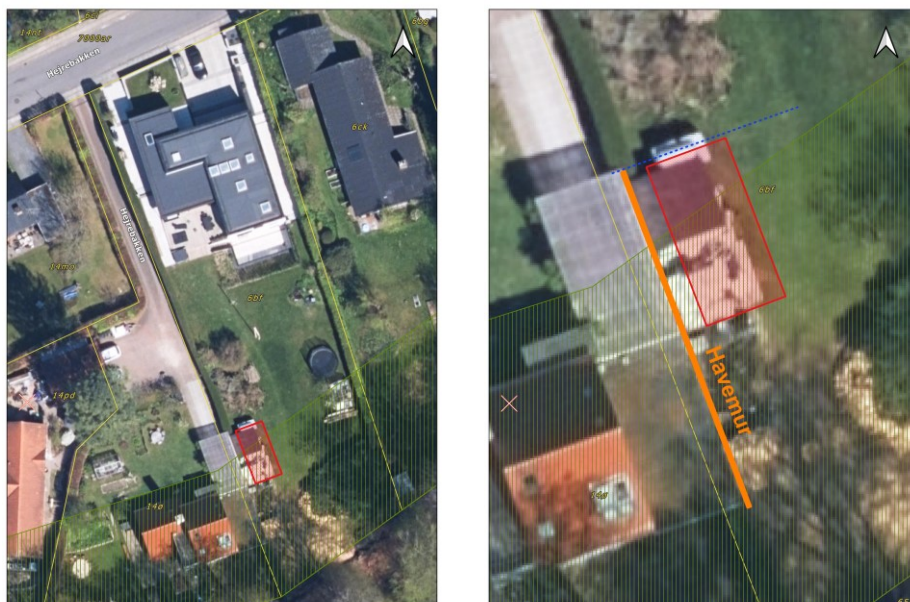
Figur 2: Skurets nye placering er markeret med rødskravering, og skovbyggelinjen er markeret med grønskravering. Havemuren i skel mod nabo er markeret med orange. Skuret placeres, så skurets nordlige facade flugter med havemurens begyndelse (illustreret med blå linje).
